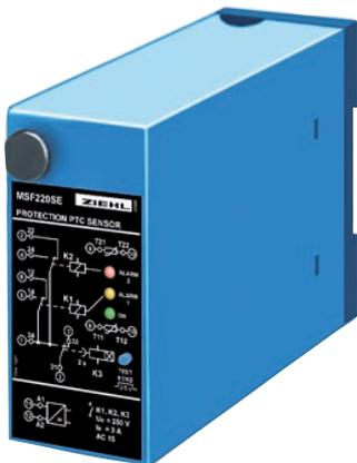
Das MSF220SE ist ein 2-kanaliges Kaltleiterauslösegerät. Es wird überall dort vorteilhaft eingesetzt, wo beim Anlegen der Versorgungsspannung eine Fehlermeldung kurzzeitig unterdrückt werden muss.
