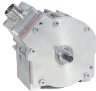
Auf der Welle des Stellgeräts ist ein mehrpolig magnetisierter Dauermagnet angebracht, dem mehrere Arbeitsspulen gegenüberstehen. Mit dieser Anordnung können sehr kräftige und in beide Drehrichtungen gleich starke Drehmomente erzeugt werden. Ein Folge der getriebelosen direkten Arbeitsweise sind äußerst kurze Stellzeiten. Optional kann das Gerät mit einer Rückstellfeder ausgerüstet werden, die bei Ausfall der Spannungsversorgung das Erreichen einer Nullposition sicherstellt.
