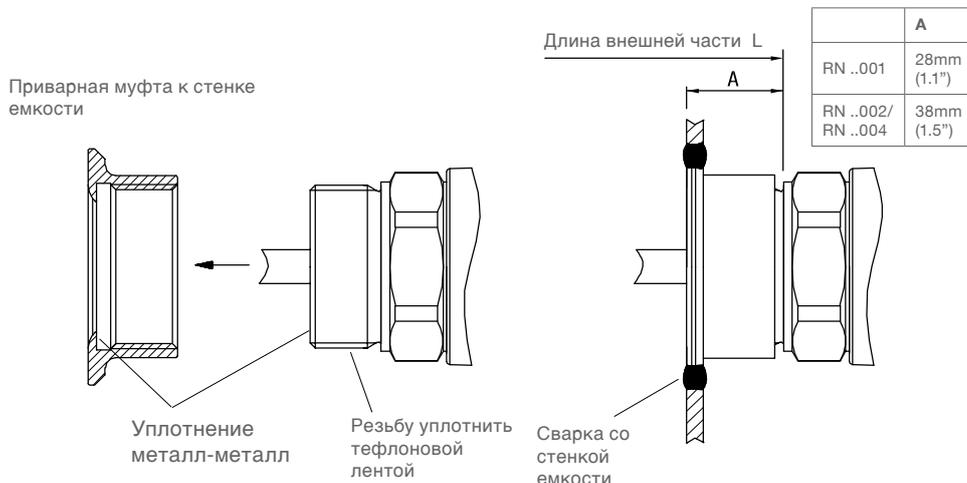
Размеры приварной муфты к стенке емкости (для самостоятельного изготовления):
