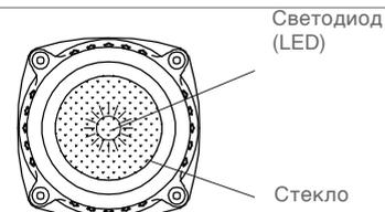
Лампа в винтовом соединении кабеля
